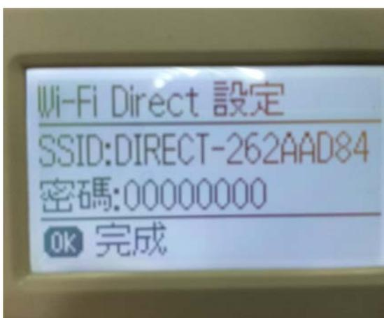
步驟 9、手機設定部分（此為 Iphone 5S IOS 7.1 版本/Android 4.4.2），要先設定無線網路，手機開啟 Wi-Fi，並選擇印表機的 SSID，如下圖選擇「DIRECT-262AAD84」。
